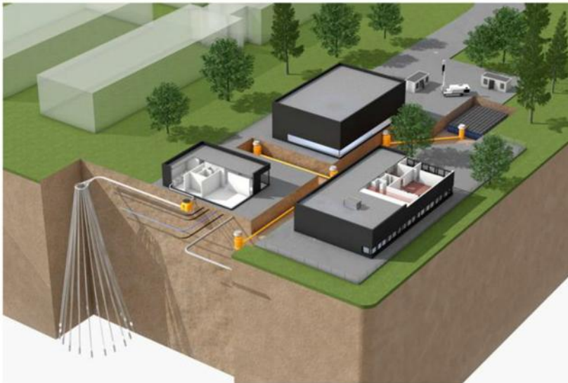
Abbildung 69 Schema Schrägbohrung Geostar (Fraunhofer IEG)
